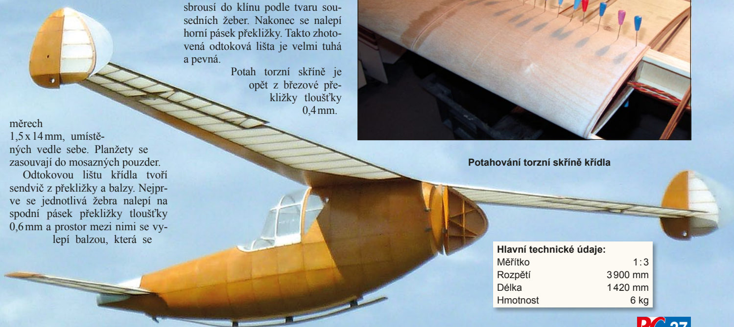
Ohýbání plátu tuhého potahu torzní skříň. V místě náběžné hrany je kulatina o průměru 8 mm, překližka je předem namočená v horké vodě.
