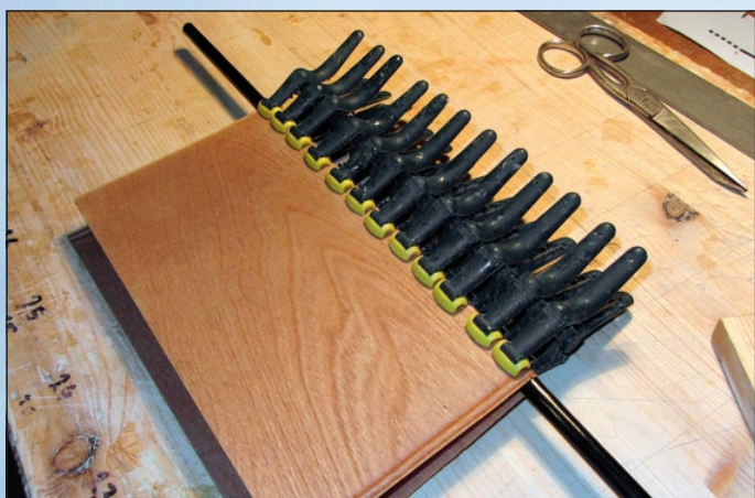
Ohýbání plátu tuhého potahu torzní skříň. V místě náběžné hrany je kulatina o průměru 8 mm, překližka je předem namočená v horké vodě.
